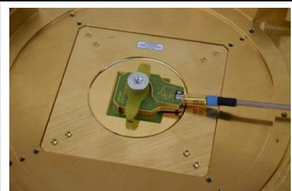
**Bild 11** Rändelschraube des **EFM 04** leicht festziehen
