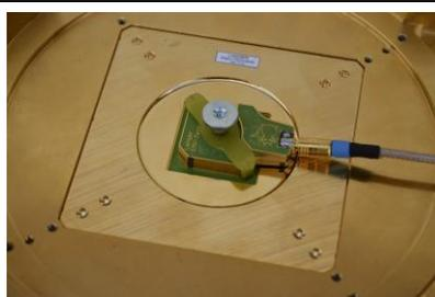
**Bild 10** Arretierung des **EFM 04** nach rechts drehen
